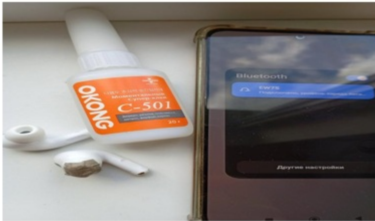
Фото 5. Блютуз наушник с тканью Фарадея. Соединение с гарнитурой установлено.
