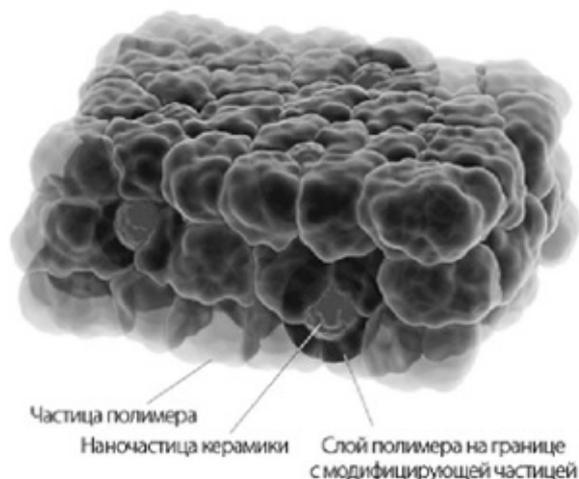
Рисунок 1 — Схема полимерного нанокompозита с наночастицами керамики
