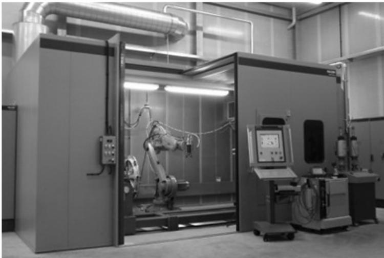
Рисунок 3 — Система напыления «Sulzer Metco»
