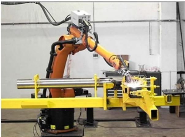
Рисунок 1 — Робот манипулятор выполняет операцию «Сварка»
