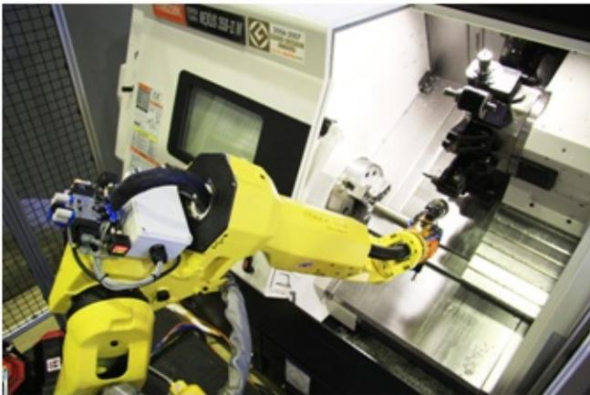
Рисунок 2 — Робот манипулятор устанавливает заготовку в станок
