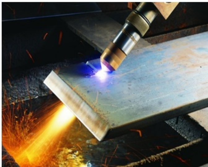
Рисунок 1 — Изменение угла резания плазмотрона
