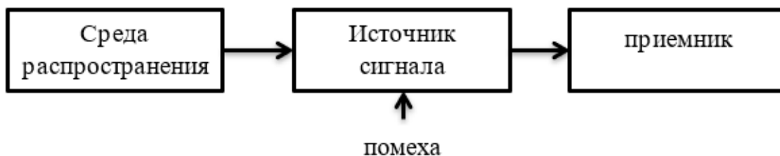
Рис. 1 принципиальная схема технического канала утечки информации
