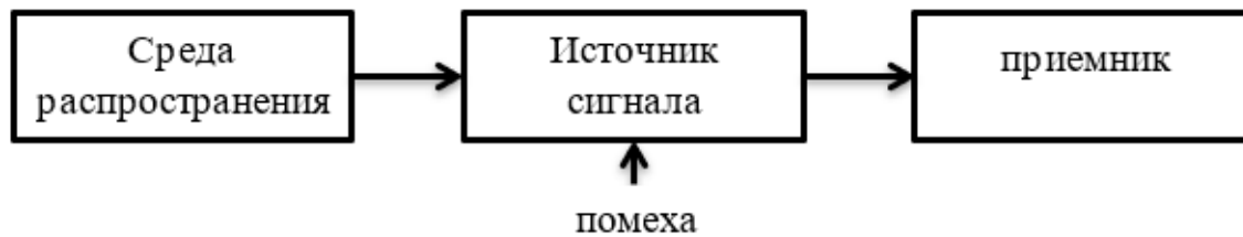
Рис.3 схема прямого акустического канала утечки речевой информации
