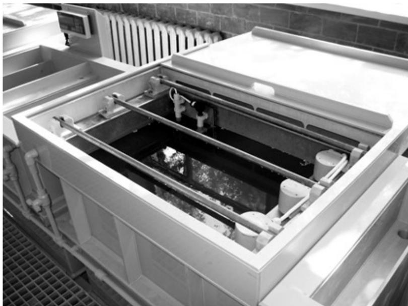
Рисунок 2 — Гальваническая ванна
