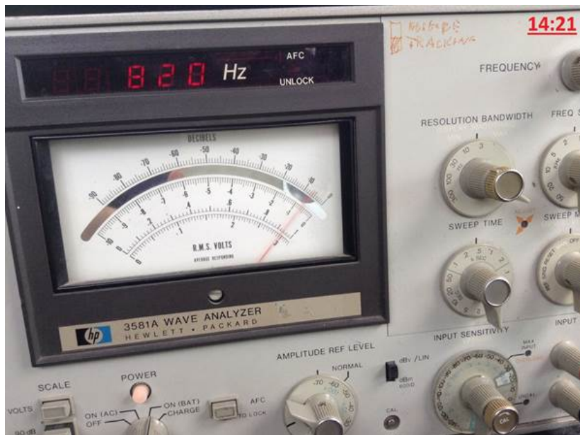
Фото.11. Показание принятого сигнала Антенной MAN № 8 на дистанции 360 м
