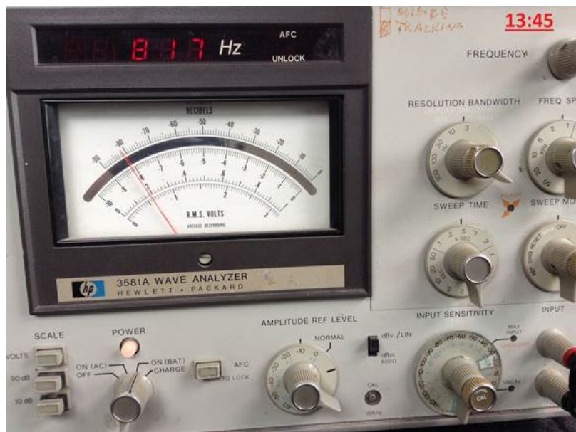
Фото.8. Показание принятого сигнала Антенной MAN № 8 на дистанции 50 м.
