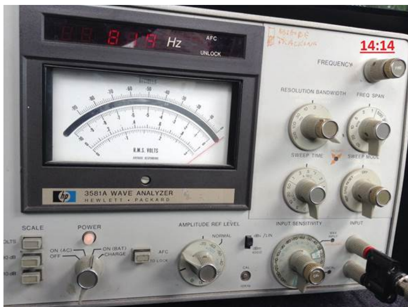
Фото.12. Показание принятого сигнала Антенной MAN № 8 на дистанции 420 м
