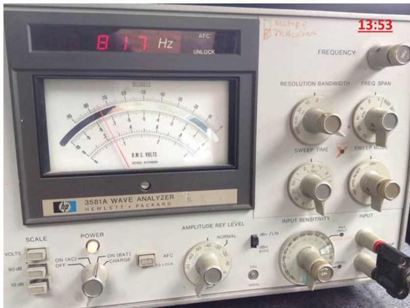
Фото.9. Показание принятого сигнала Антенной MAN № 8 на дистанции 180 м.
