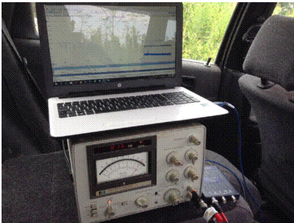
Фото.7. Расположение регистрирующей аппаратуры сигнала от MAN № 8, закреплённой вне салона.
