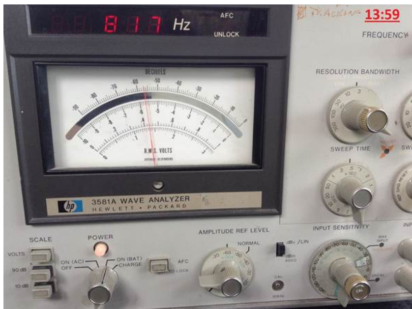
Фото.10. Показание принятого сигнала Антенной MAN № 8 на дистанции 330 м
