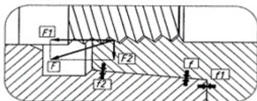
Рисунок 3 — расположение сил в крепежном устройстве
