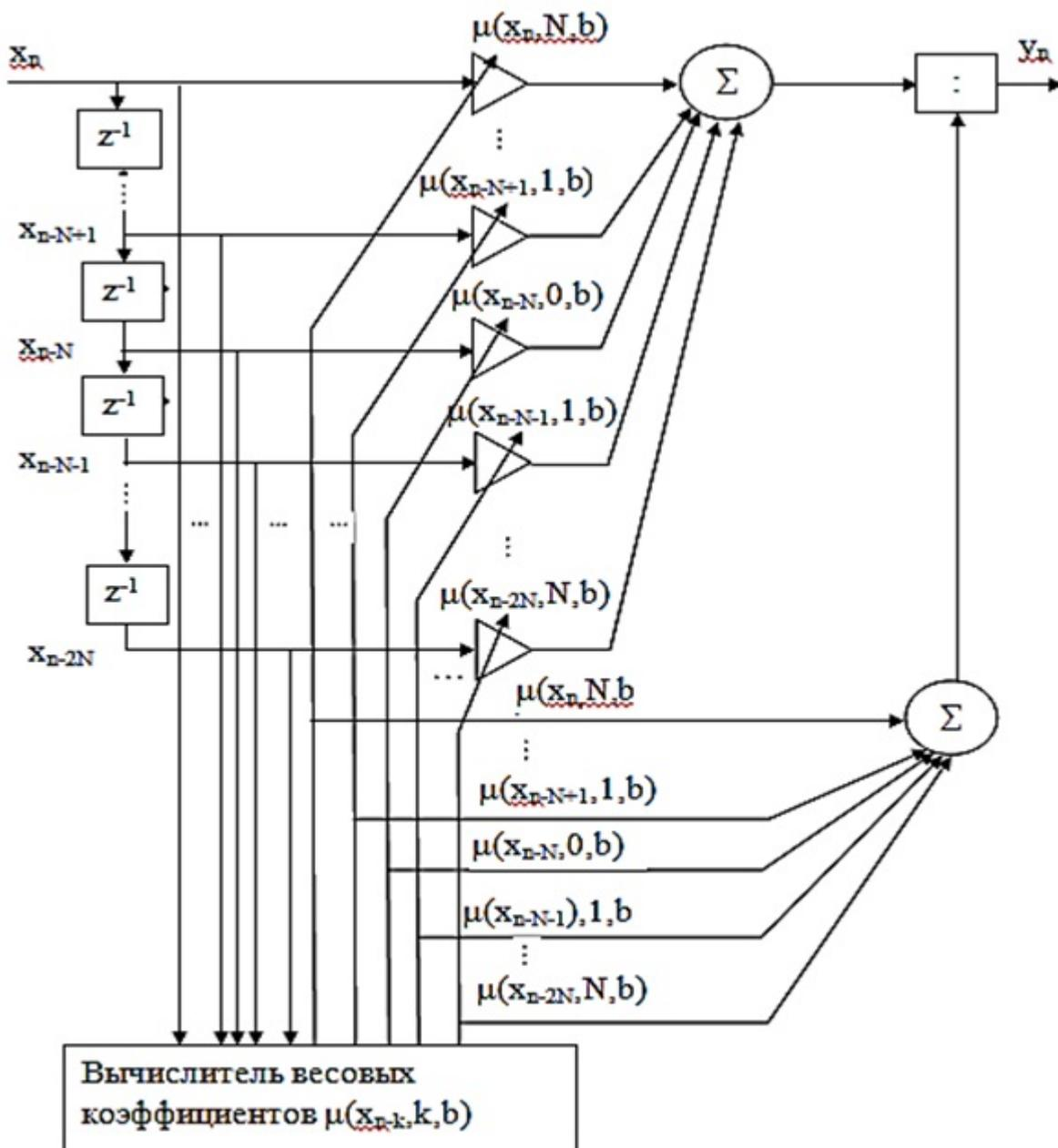
Адаптивный цифровой фильтр с данным алгоритмом обладает следующими характеристиками (при частоте дискретизации сигнала 250 Гц и  $N=4$ ):
