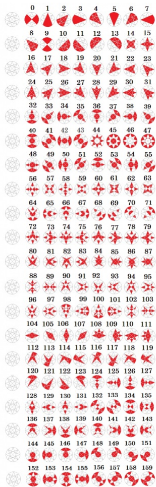
Формирование 160 знаков на основе формата в виде круга с 32-мя элементами отображения Рис.6
