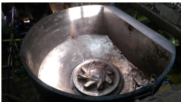
Фото 1. Бак с ротором гидроразбивателя.
