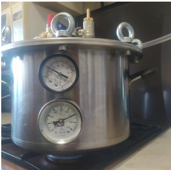
Фото 3. Внешний вид автоклава в работе. Достигнуты заданные параметры в 120 С и 1 атм.
