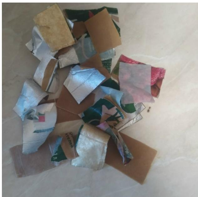
Фото 4. Результаты распуска тетрапака в автоклаве после извлечения из устройства, неупорядоченный вид.
