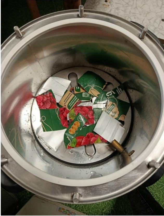
Фото 2. Закладка показательной порции тетрапак-упаковки в автоклав для парового метода воздействия.
