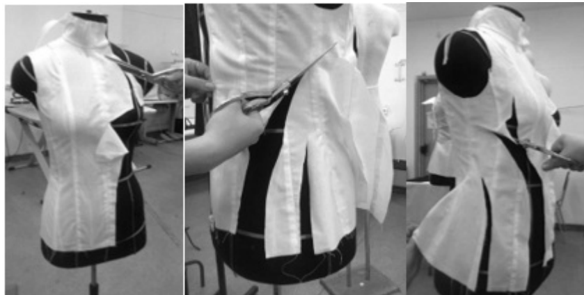
Рисунок 2. Процесс разрезание макета по модельным линиям
