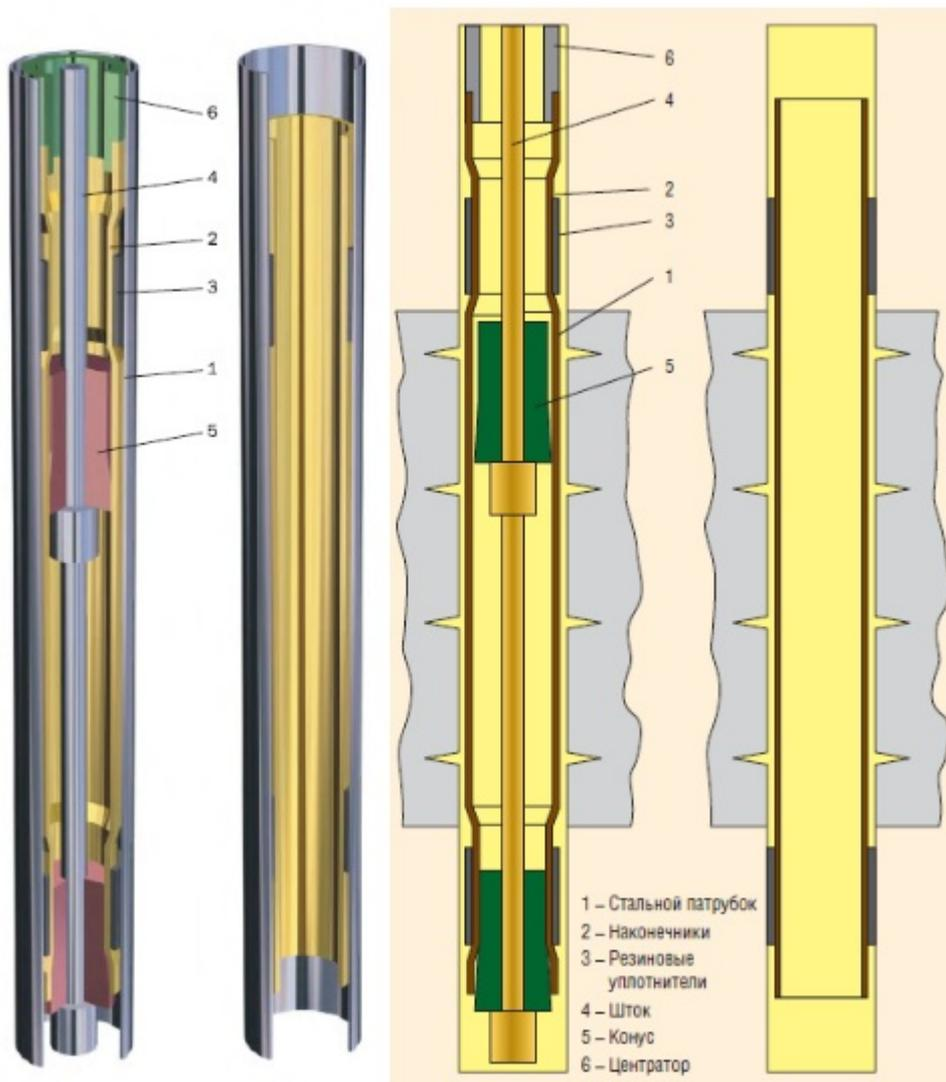
Рис.1 Схема устройства в транспортном и установленном положении
