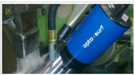
*Рисунок 2 — Измерительная система Optosurf 500*
