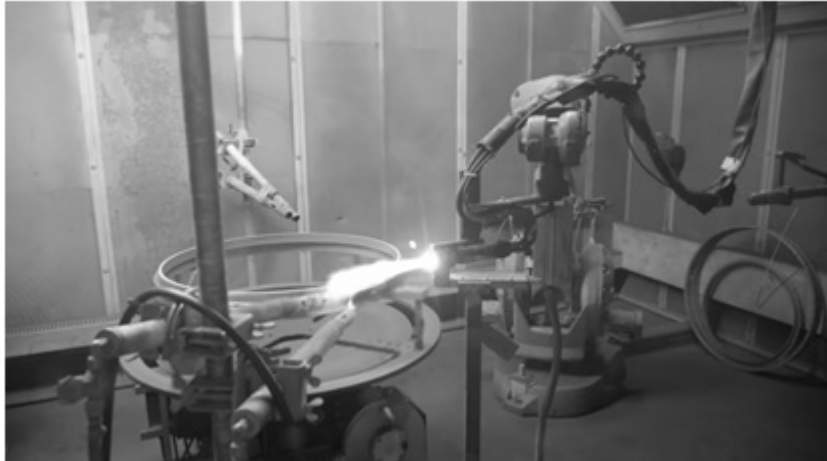
Рисунок 4 — Процесс плазменного напыления
