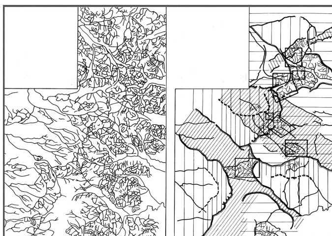
Рис.17. Лжеструктурная схема (справа), полученная с помощью графического изображения фотографического рисунка (слева). Здесь же показаны участки поисковых работ, выделенные на основании “лжеструктурных элементов”.
