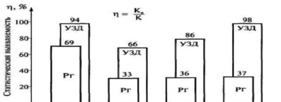
Рис. 2. Сравнение выявляемости между ультразвуковым (УЗД) и радиографическим (Рг) методами ( где К — общее количество дефектов; К<sub>в</sub> — количество выявленных дефектов).
