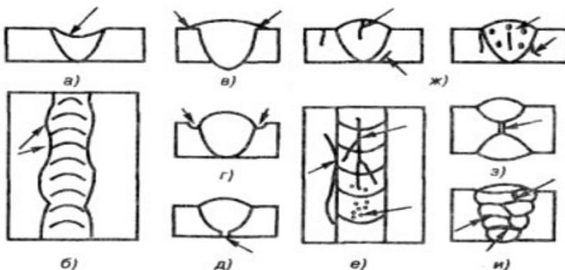
Рис. 1. Виды дефектов сварных соединений (где а — ослабление шва, б — неравномерность ширины, в — наплыв, г — подрез, д — непровар, е — трещины и поры, ж — внутренние трещины и поры, з — внутренний непровар, и — шлаковые включения).
