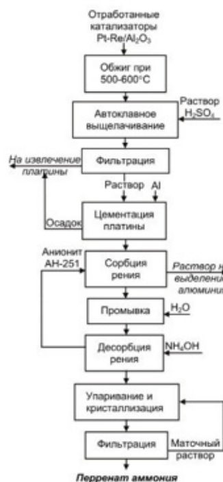
Рисунок 1 — Схема переработки Al-Pt-Re катализаторов с предварительным обжигом и растворением основы в серной кислоте
