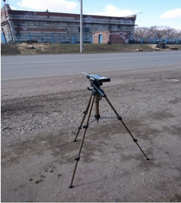
Рисунок — Пример установки шумомера (фото автора)
